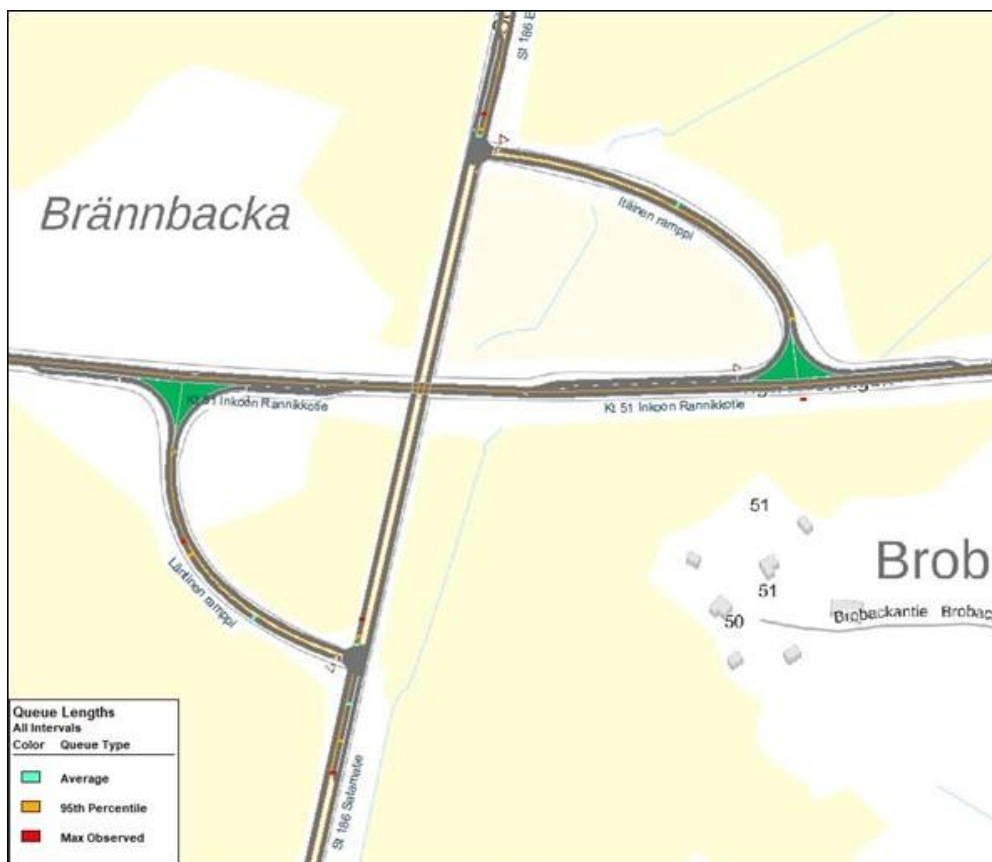
Kuva 27. Eritasoliittymän jonoutuminen huipputuntina rakentamisen aikaisessa tilanteessa nykyisillä liikennejärjestelyillä.
